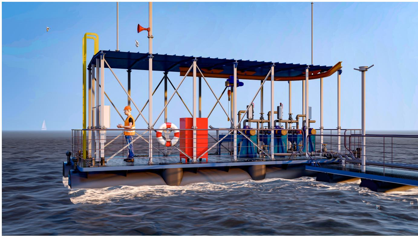
**Архитектурно-конструктивный тип** – стоечная несамоходная сборно-разборная плавучая нефтеперекачивающая насосная станция.
