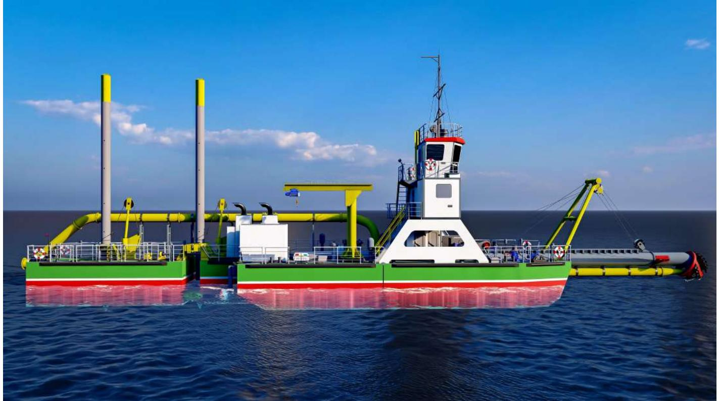
**Тип судна** – несамоходный сборно-разборный, землесосный снаряд, с механическим рыхлителем (фрезой), свайно-тросовым папильонажем и устройством перемещения.
