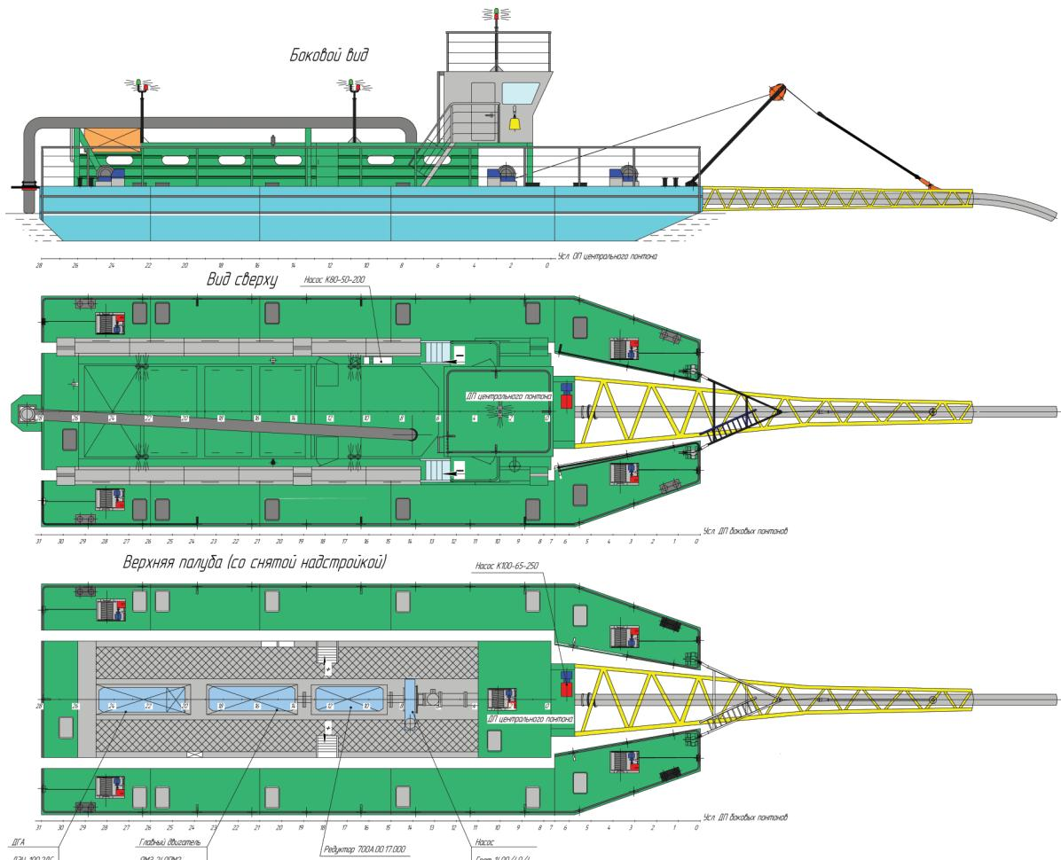
Назначение земснаряда - добыча строительного песка и гравия из обводненных карьеров, очистка русла рек и каналов, строительство каналов. Плавучий разборный несамоходный земснаряд с гидроразмывом состоит из трех pontонов (центрального и двух боковых). Перевозится к месту выполнения работ автотранспортом. Понтоны соединяются при помощи болтов.
